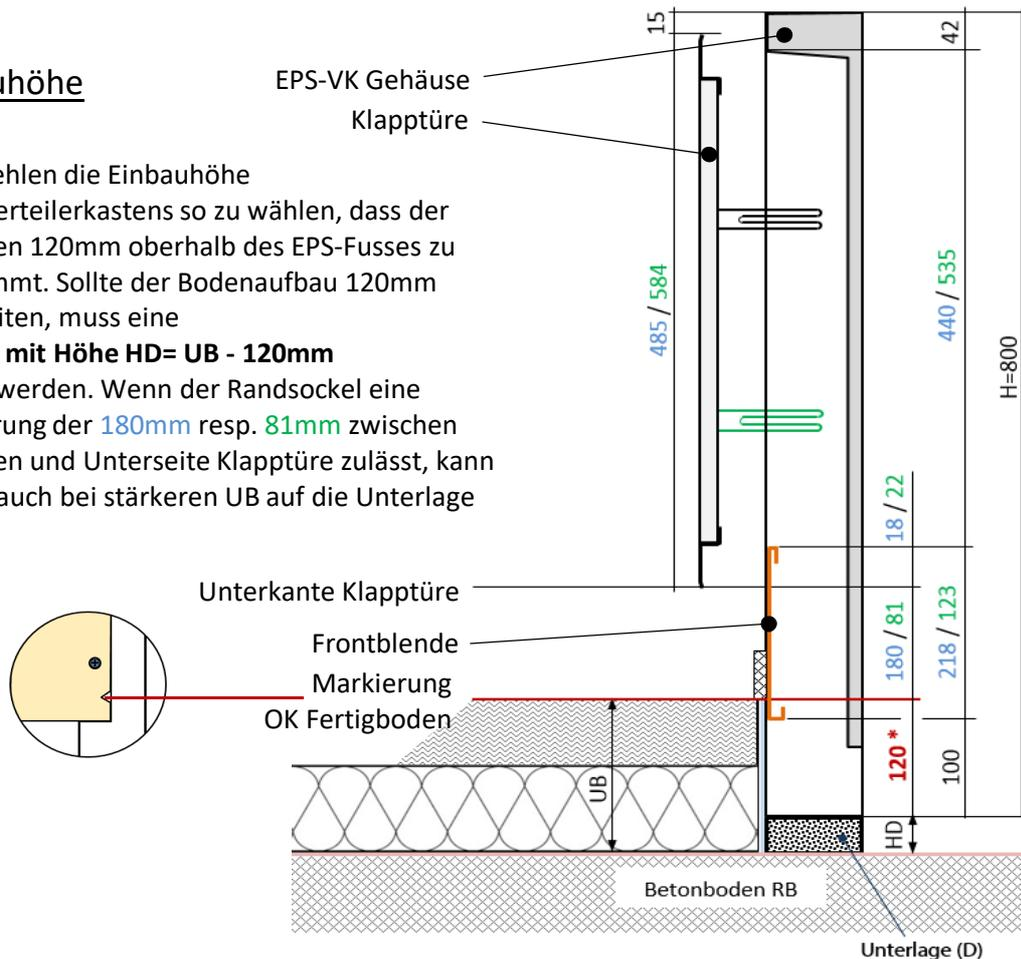
Um die Überdeckung des Mauerausschnitts durch die Türe zu gewährleisten, sollte der EPS-VK bis über den Kastenrand sauber vernetzt und verputzt werden:
